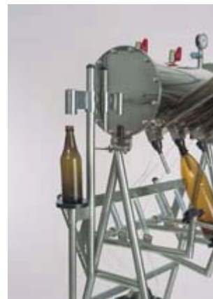
укупорочный механизм для кронен корки
